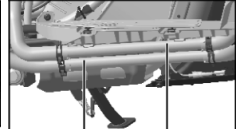
Şekil 4 Giriş borusu Çıkış borusu
